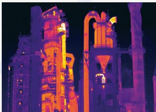
2. Kuantitatif *Thermography* berfokus kepada kemampuan untuk pengukuran suhu dengan membandingkan suhu objek dengan suhu operasi normal. Contohnya Inspeksi elektrikal panel dan mekanikal.
